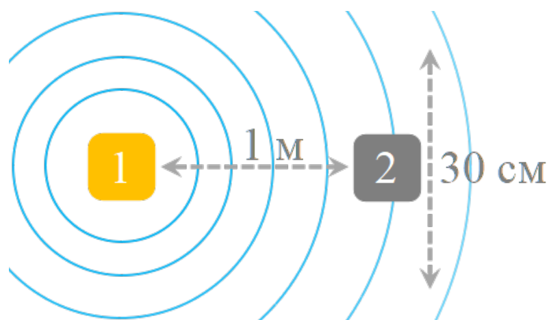
Рисунок 11. Местоположение метки относительно приёмного устройства
